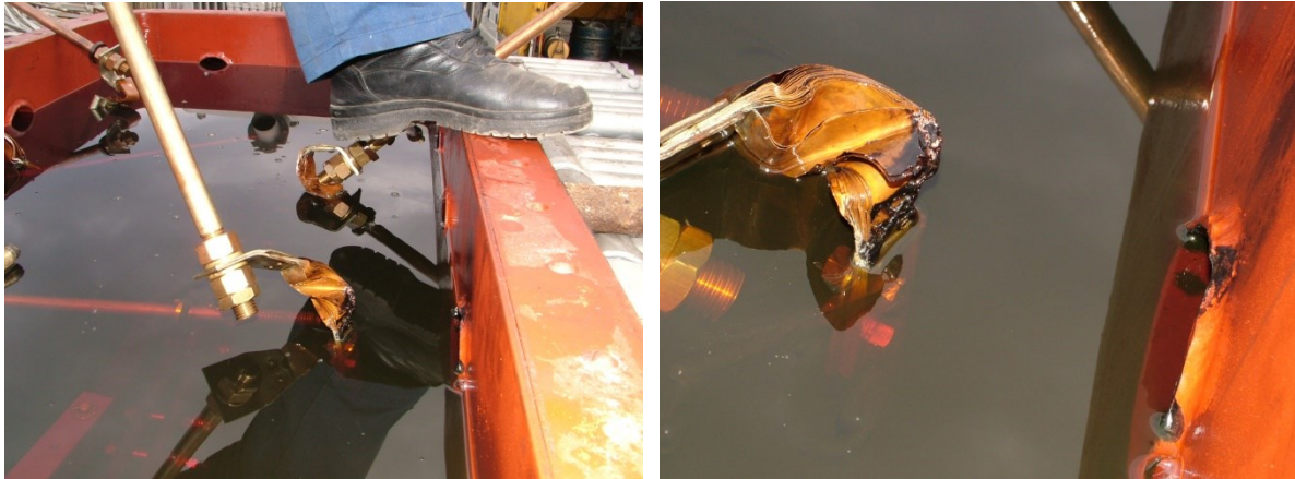
Slika 2 – Mesto električnog luka od savitljive veze do suda ET
