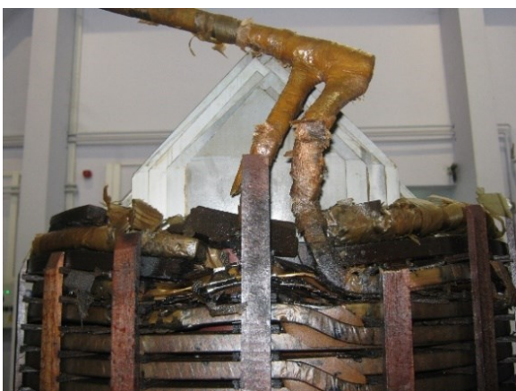
Slika 7 – Oštećenja usled kvarova na niskonaponskom namotaju faze “b”
