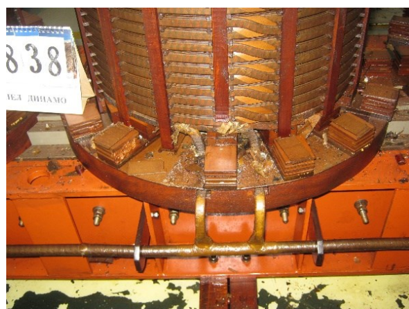
Slika 7 – Oštećenja usled kvarova na niskonaponskom namotaju faze “b”
