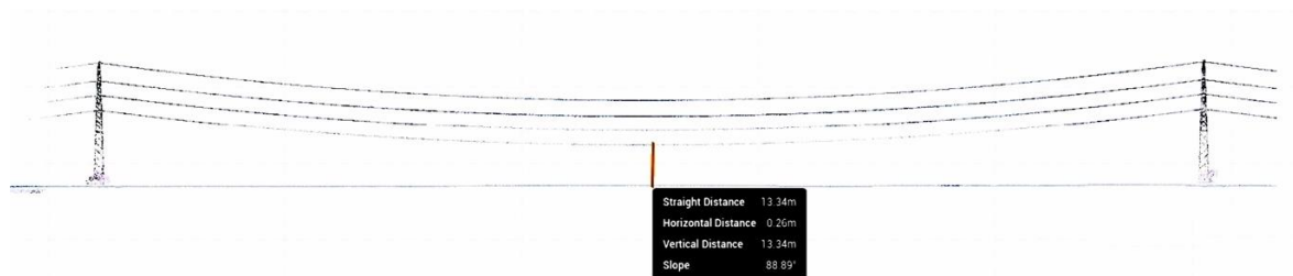
Слика 3 - Пример подужног профила надземног вода 110 kV дуж једног распона. (Слика екрана софтвера DJI Terra)
